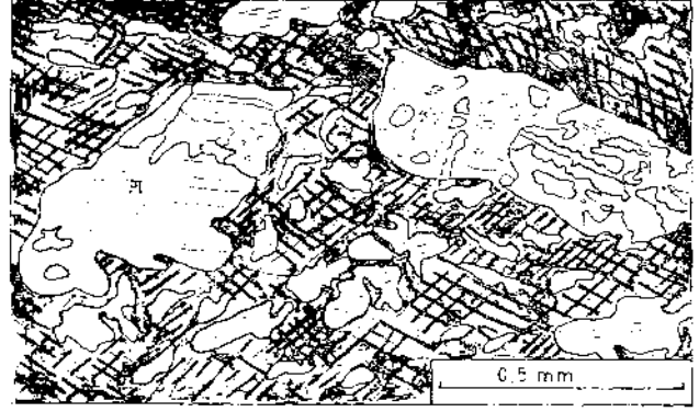
Şekil 3 : Lice-Kulp yöresindeki masif amfibolitlerden alınan bir örnekte (Örnek No TK 15) gözlenen serizitleşmiş ve epidotlaşmış, uzun plajiyoklas (Pl) kristallerinin mikroskop altındaki görünümü (çapraz nikelde).
